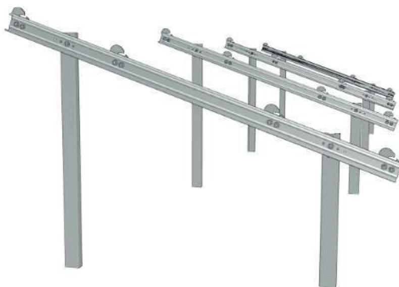
Figure 11 : Modèle de structure sans les modules
