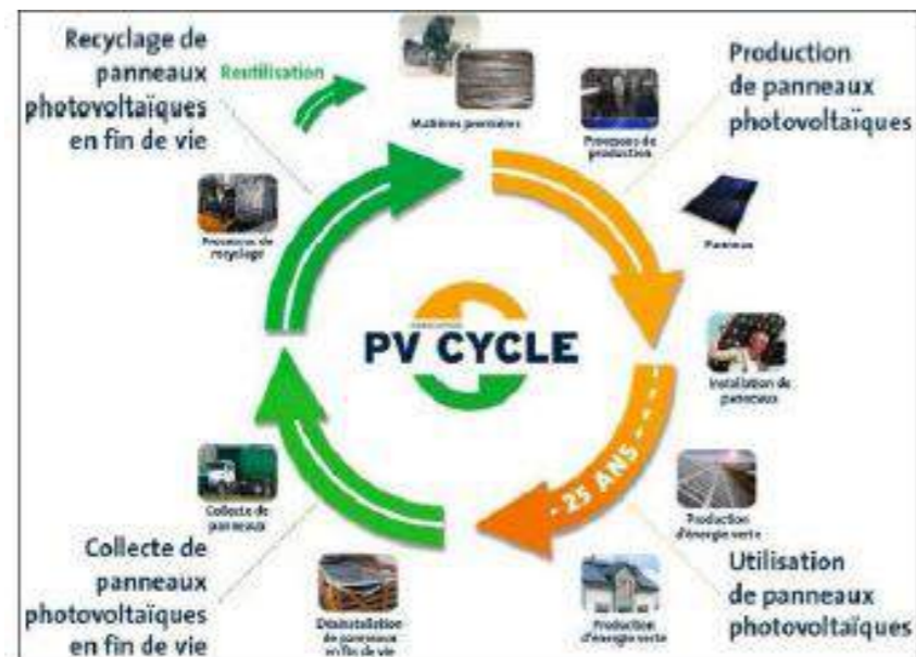
Analyse du cycle de vie des panneaux photovoltaïques en silicium cristallin (source : SOREN)
