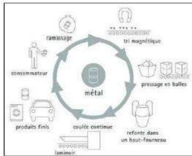
Recyclage des structures porteuses
