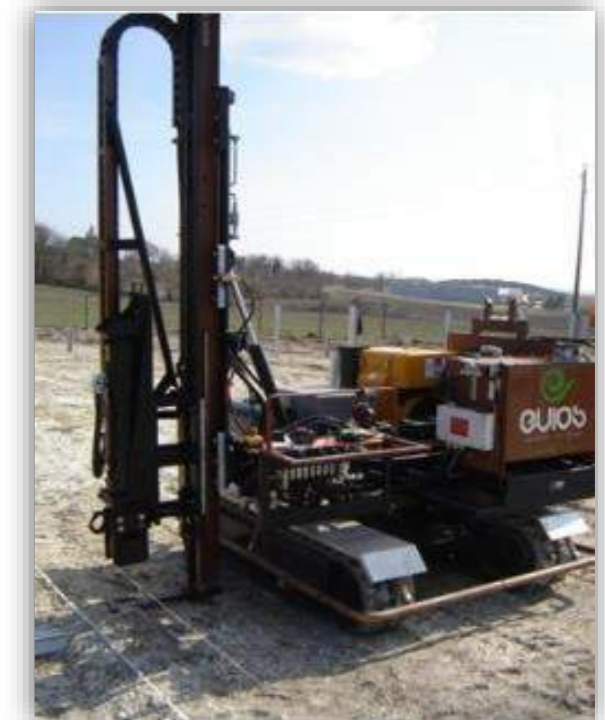
Engin de battage de pieux
